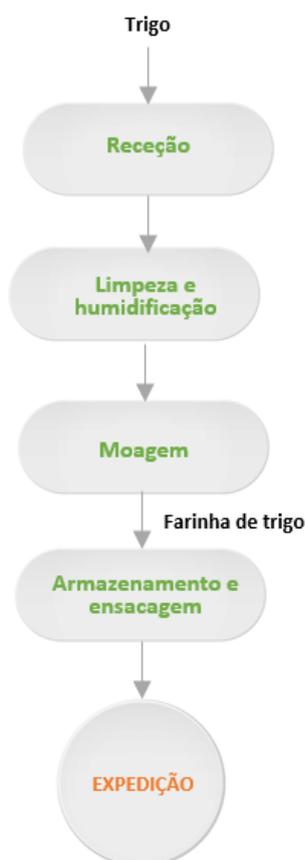
Figura 1 Fluxograma simplificado do processo produtivo
