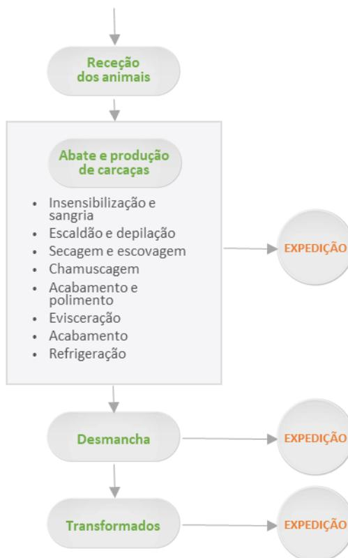
Figura 1 Fluxograma simplificado do processo produtivo
